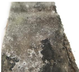
Obr. 39 Ocel 1.4404 (1,0 mm, PRIMA) – vnitřní strana
