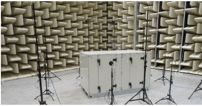
Obr. 2 Model box v akustické komoře Fig. 2 Model box in an acoustic chamber
