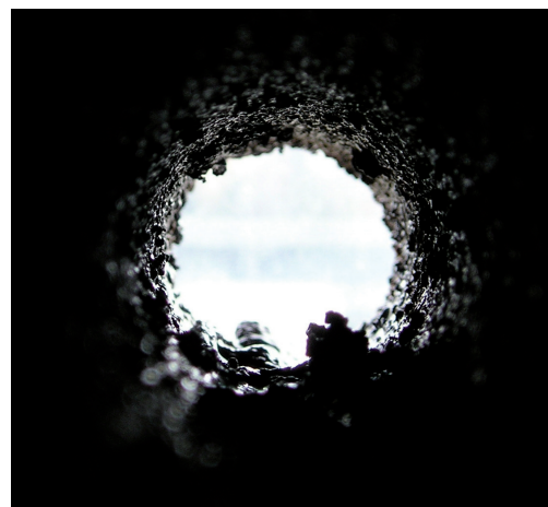
Obr. 8 Výměnné kontrolní potrubí cirkulace po 60 dnech: a) pohled na vnitřní povrch potrubí; b) průhled potrubím
