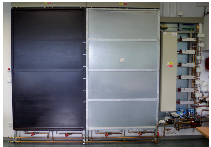
Obr. 9 Akumulační panely s originálním a upraveným povrchem Fig. 9 Accumulation panels with original and modified surface
