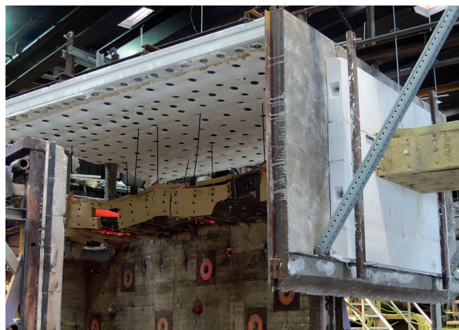
Obr. 3 Vzorek ZOKT multi bezprostředně po skončení 120minutového testu s podtlakem 500 Pa
